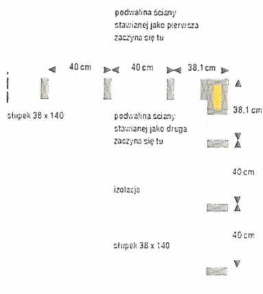
Rysunek 6. Rozpoczynając rozmierzanie należy pamiętać, iż dla ścian zewnętrznych o rozstawie 40 cm pierwszy wymiar od narożnika zewnętrznego budynku, do krawędzi pierwszego słupka, wynosić będzie 38,1 cm, tj. pomniejszony o 1,9 cm będącym 1/2 grubości narożnego słupka.
